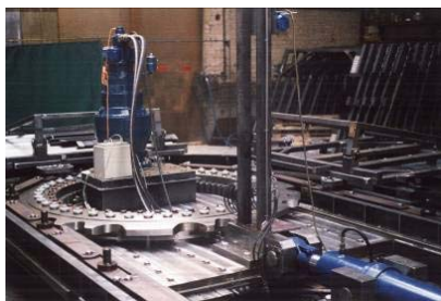
Mides ontwierp een carousel met 69 spuitmoules voor Depecker Gent (matrassen – latex industrie)
